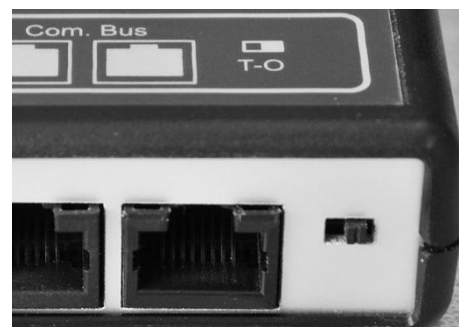
BSP-Terminierung deaktiviert (O-Stellung)
